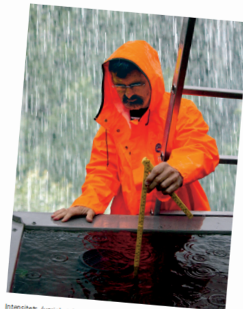
Intensitets-/varighetskurver for regn gir grunnlag for dimensjonering av taknedløp. Foto: SINTEF Byggforsk
