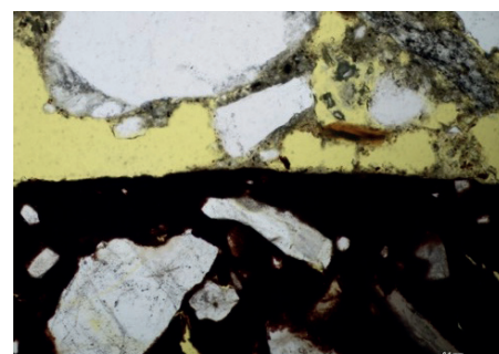
FIGUR 1. Tynnslianalyse av heftsoner mellom teglstein (nede mørke del) og murmørtel. Gule felt markerer luftporer. Analyse og foto: Marit Haugen, SINTEF Byggforsk.
