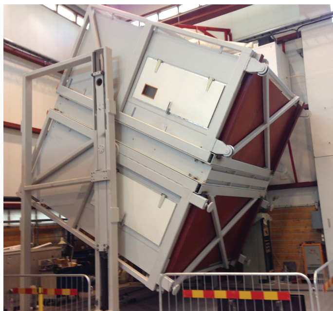
U-verdi måling på prøvefelt innmontert i Hot-Box og orientert som tak med 30° vinkel. Prøvefeltet er plassert mellom to kammer der det varme rommet (innetemperatur) er nederst og det kalde rommet (utetemperatur) er øverst. Foto: Lars Gullbrekken.
