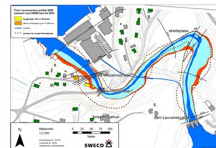
Figur 2-4 Kart fra dambruddsberegningen 2003 (blå og rød sone viser utbredelse av Hiv Qd1m og D80) og skader fra Rommen 2006 (erosjonsområder markert med stiplet strek)
