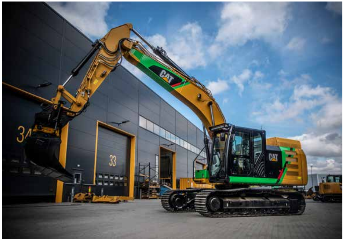
Fossilfri. Den revolusjonerende fossilfrie gravemaskinen går på i låneprosjekt i samarbeid med Statsbygg i Oslo sentrum. Maskinen lades med 63 ampersikring og har syv timers brukstid. Ladetid, også syv timer.
