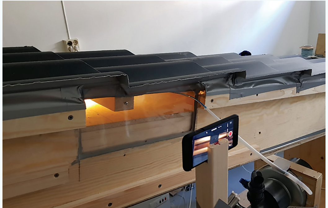
Figur 1: Luftstrømmens forløp under taktekningen er filmet ved hjelp av røyk og spesiell lyssetting. Foto: Olaf Rør.
