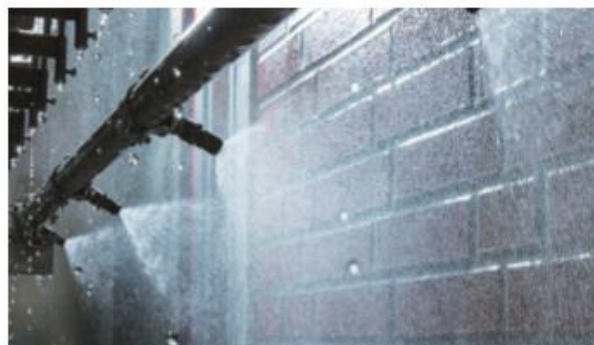
Slagregnpøving av teglfelt før og etter impregnering viser liten effekt av impregneringen på regnmotstandsevnen. Foto: Geir Mogen.
