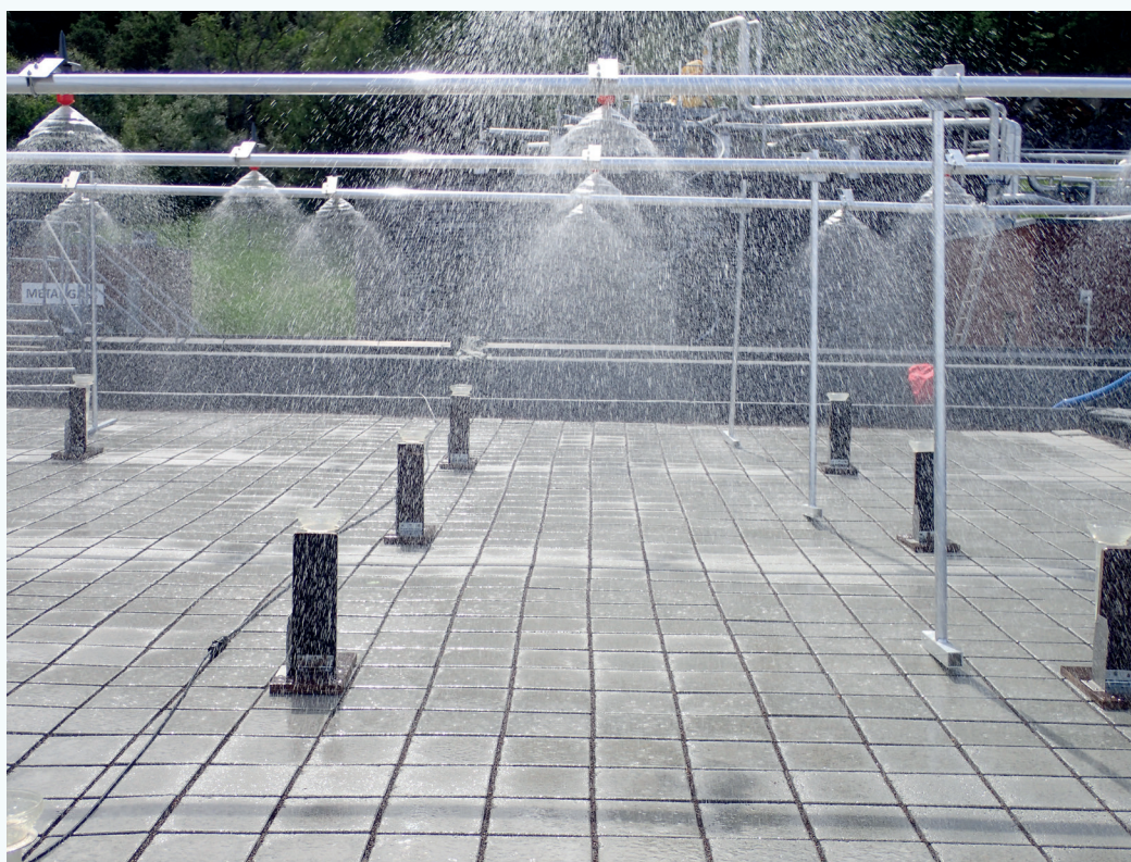
Trondheim kommune har sammen med Klima 2050 etablert en egen feltstasjon på Høvringen avløpsrenseanlegg for utvikling av blågrønne og blågrå tak som aktive element i framtidig overvannshåndtering. Anlegget er utstyrt med egen regnrigg for påkjønning av forsøksfeltene med 200-årsregn. Foto: Tore Kvande.
