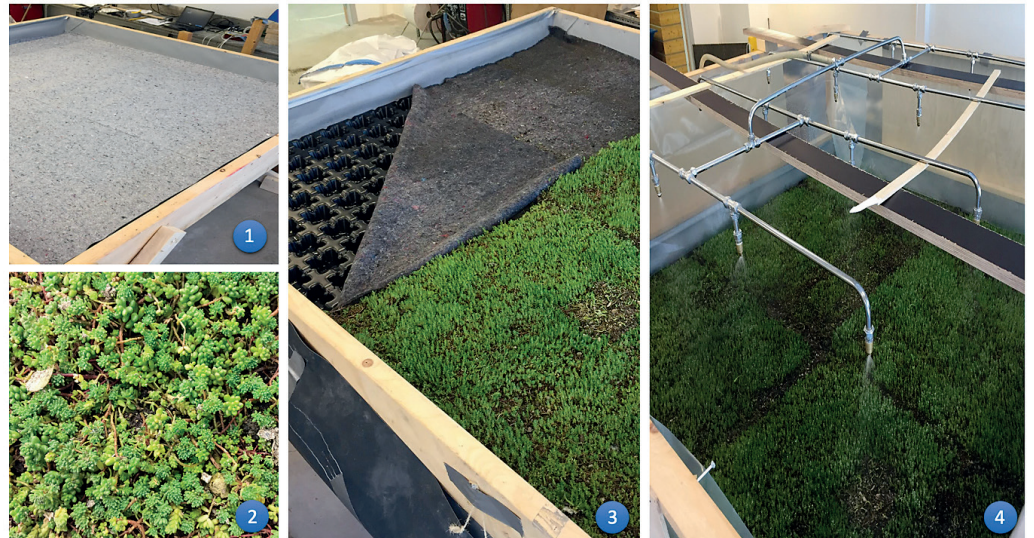
Lab forsøk for måling av avrenningskoeffisienter fra grønne tak. 1: Trekkasse for testing av ulike materiallag. 2: Sedumvegetasjon for grønne tak. 3: Lagvis oppbygning av et av de grønne takene. 4: Sprinkelsystem som simulerer nedbørshendelser. Foto: Lotte Askeland Schärer
