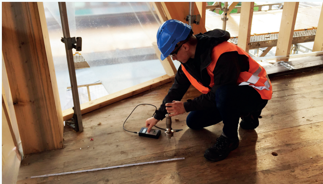
Fuktmåling i massivtredekket i ZEB-laboratoriet.
